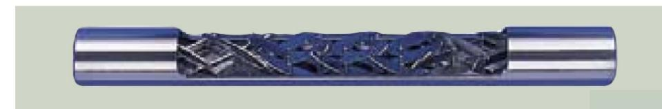
**SMXL** – смесительная вставка для существенной интенсификации теплопередачи в трубах кожухотрубчатых теплообменников. Находит применение в случаях тепловой обработки вязких и термолабильных жидкостей, когда локальные перегревы жидкостки на теплообменной поверхности ведут к термической деградации и потере продукта.
